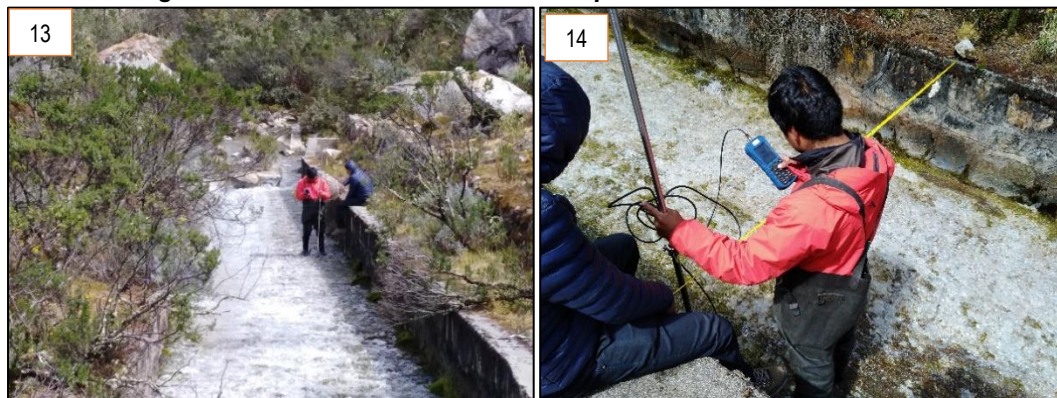
Fotografía N.º 15: Estimación de Caudales por el Método del Correntómetro
