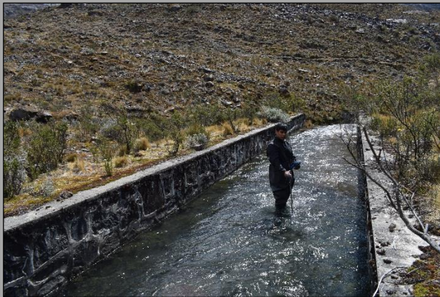
Fotografía N.º 9. Aforo en la descarga de la laguna Pucacocha
