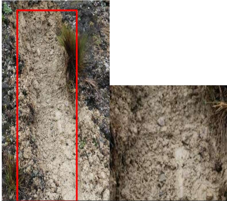
Fotografía N° 5: Corte, talud de la morrena lateral Izquierda de la laguna Cancarcá, donde evidencia suelos de composición gravo arcillosas con mucha humedad, por las filtraciones de agua ha generado un suelo pastoso con mucha plasticidad, produciendo desprendimiento.
