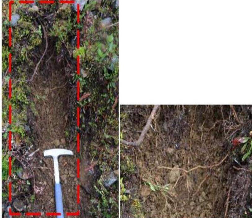
Fotografía N° 4: Corte de suelo, talud de la morrena lateral izquierda de la laguna Yanaraju, evidencia suelos de presencia literalmente finas compuestos por gravas arcillosas envueltas en una matriz limo arcillosa , evidencia la humedad.
