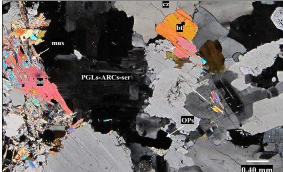
Fotomicrografía en LT-NX: Cristales subhedrales de plagioclasas alterados por arcillas y sericita (PGLs-ARCs-ser), blastos de cuarzo con extinción ondulante (cz), biotita subhedral (bt) junto con muscovita (mus). Además minerales opacos diseminados (OPs).
