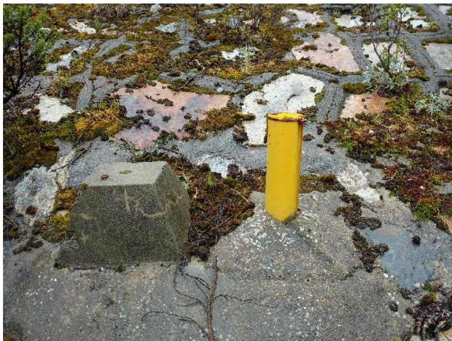
Fotografía N° 15: Vista del hito topográfico y cabezal del piezómetro.
