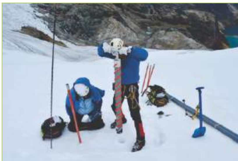
Fotografía 11. Perforaciones para obtener la densidad del glaciar en la zona de acumulación en el glaciar Ticlla
