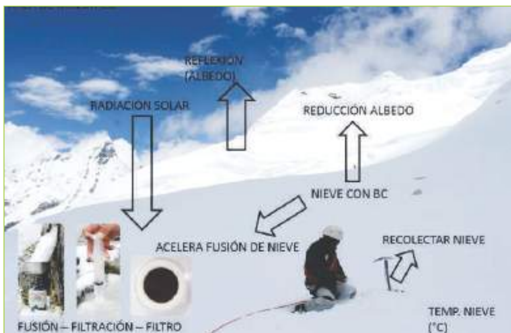
Figura 7. Proceso de influencia del carbono negro en el derretimiento de nieve/hielo
