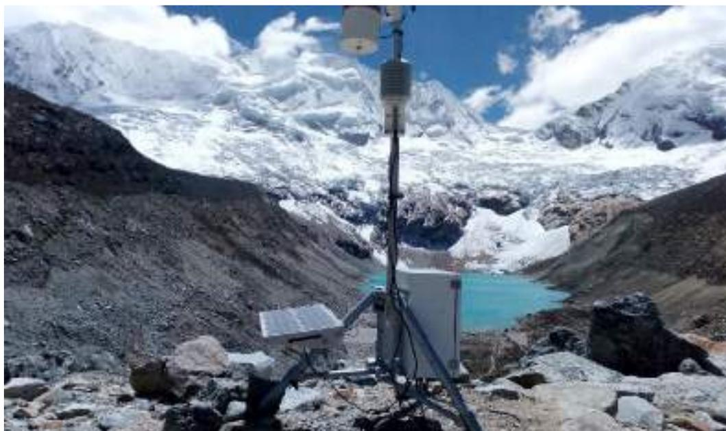
Fotografía 27. Estación meteorológica automática ubicada en la morrena frontal de la laguna Palcacocha, en donde se tiene registro cada cinco minutos de variables como temperatura máxima, temperatura mínima, humedad relativa y precipitación.
