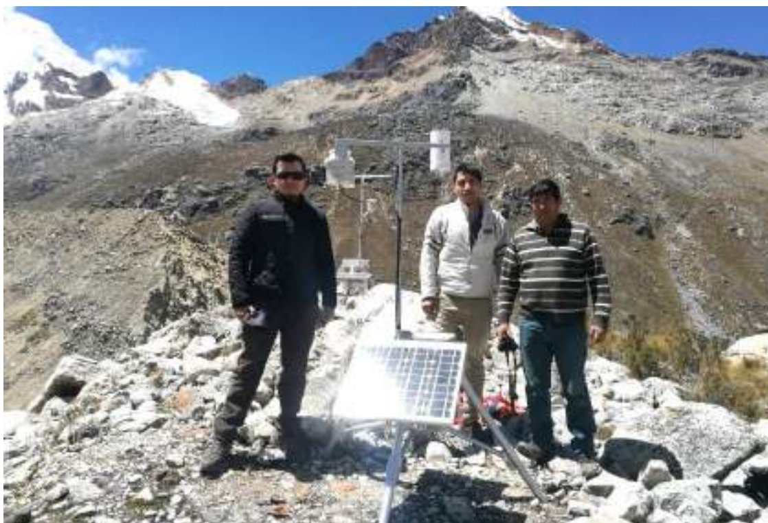
Figura 45. Estación meteorológica elaborada con Arduino, instalada en la morrena frontal de la laguna Palcacocha. Desde agosto del 2018 registra las variables de temperatura, humedad relativa y precipitación cada cinco minutos.
