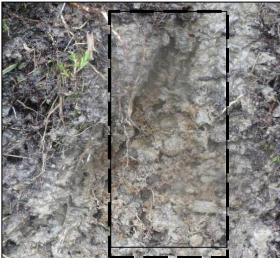
Fotografía N° 04: Se observa un material mixto compuesto principalmente de gravillas de litología granodiorítica intercalada con presencia de materiales finos como limos y arenas.
