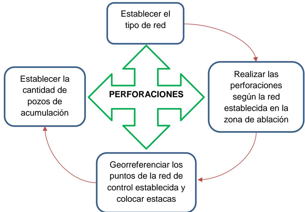
*Figura N° 2: Actividades de la perforación sobre superficie glaciar.*
