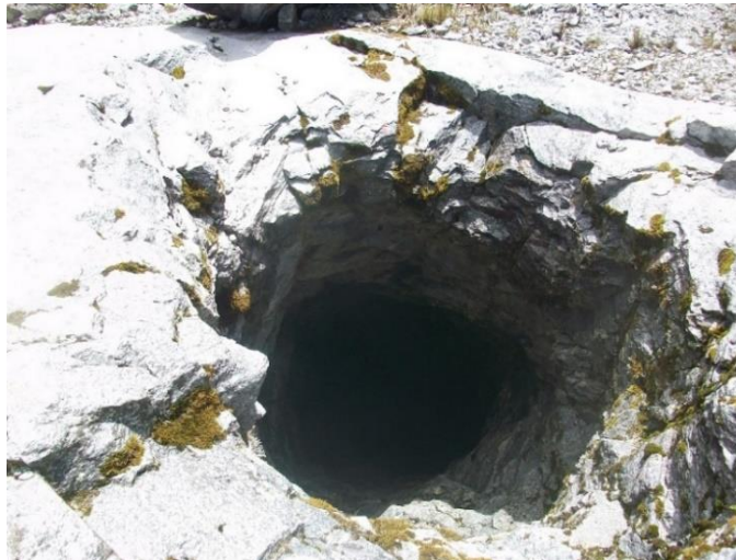
Fotografía N° 08. Se muestra el pique excavado en roca.
