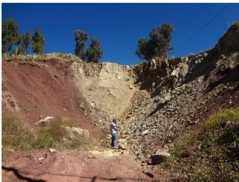
Fotografía 2: Bloques de rocas acumulados en el pie de taludes, formando material coluviales.
