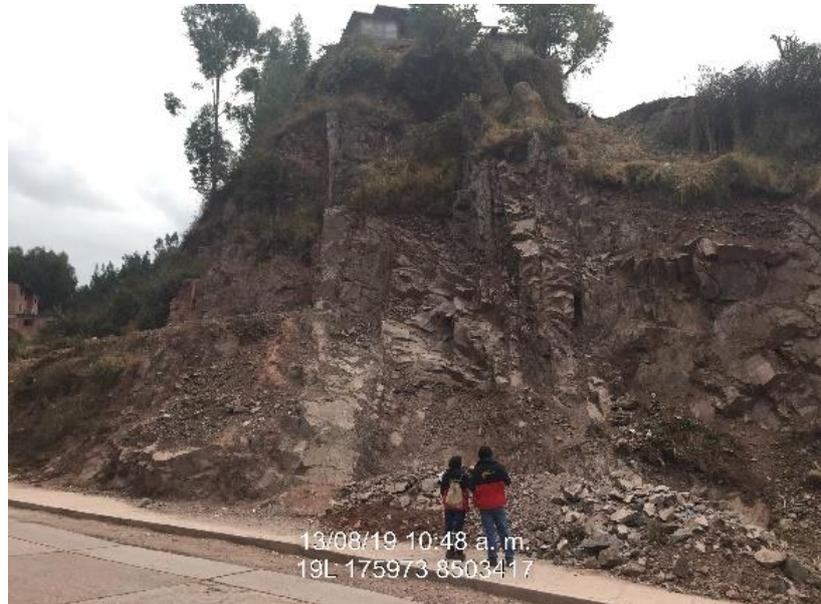
Fotografía 10: Afloramiento rocoso de la formación Kayra de composición de areniscas con intercalación de lutitas rojas
