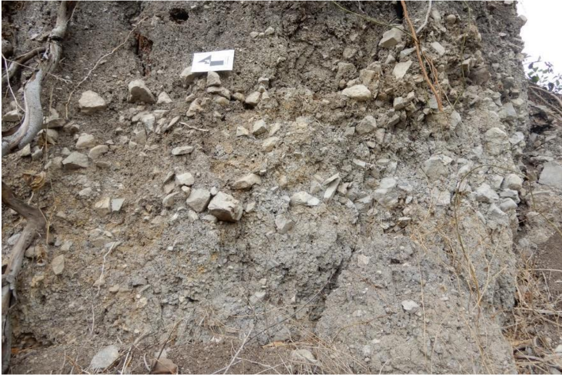
Fotografía 2. Depósito coluvio deluvial clastos y bloques angulosos, envueltos en una matriz limo arcillosa, ubicado en las coordenadas UTM WGS-84, Zona 17S, Este:814754 y Norte: 9350020.
