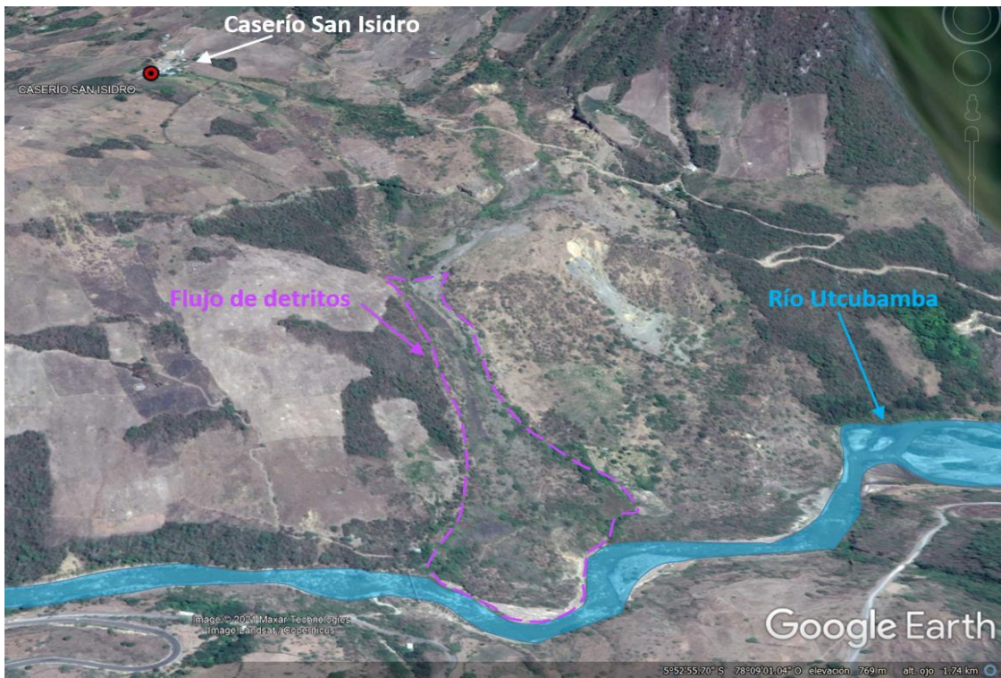
Figura 13. movimiento complejo (deslizamiento – flujo), con dirección noroeste, hacia el río Utcubamba, captura de imagen, Google Earth 2016.
