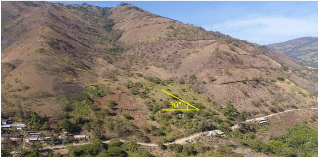
Figura 4. En el sector Los Valles, la pendiente promedio dentro del cuerpo deslizado es de 30^\circ .
