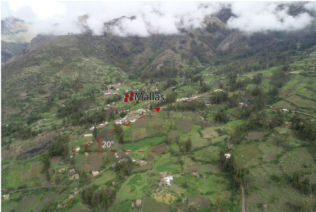
Figura 13. En el sector del centro poblado de Mallas, se estima que la pendiente promedio dentro del cuerpo deslizado es de es de 20°.
