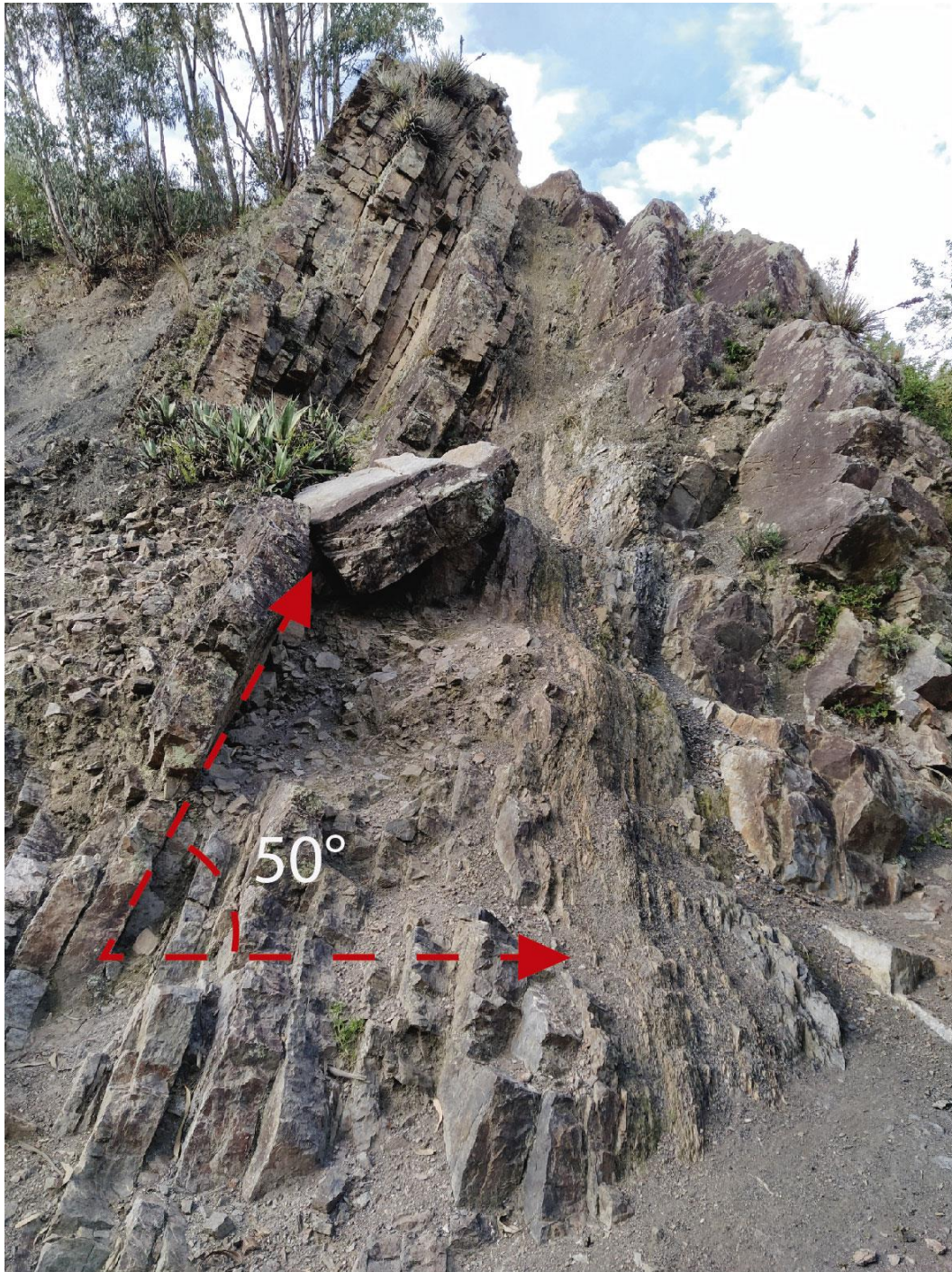
Figura 6. Se observa afloramiento de areniscas cuarzosas de grano medio, de rumbo N170°, con un buzamiento de 50° SO, pertenecientes a la Formación Oyón, se encuentran plegadas, son de resistencia media a baja debido al alto grado de fracturamiento que presentan por su cercanía al eje sinclinal, sus estratos miden hasta 50 cm de espesor.
