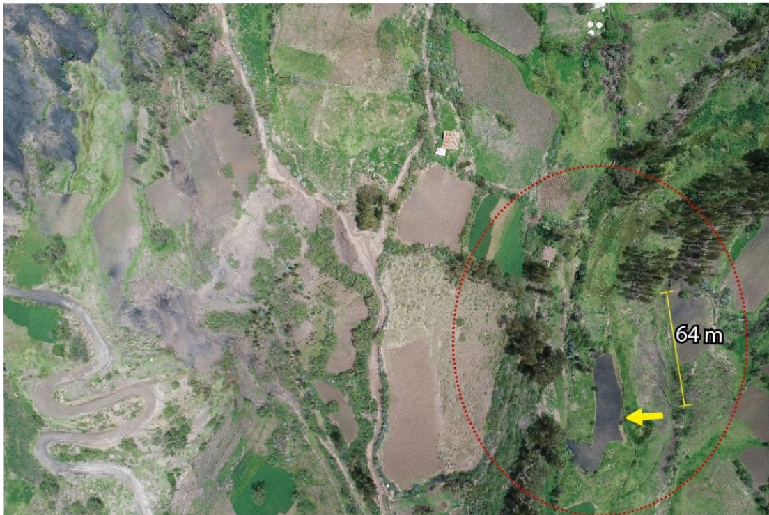
Figura 26. Vista donde se observan grietas tensionales en el cuerpo del deslizamiento 3 (DES-3), con dirección suroeste - noroeste con distancias longitudinales de hasta 64 m.
