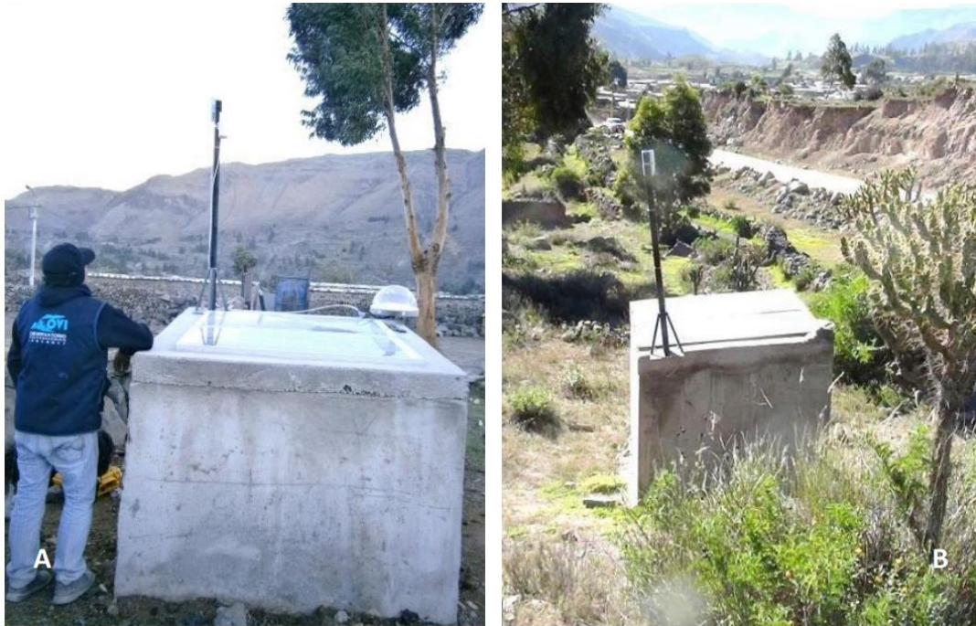
Figura 36: Ejemplo de estaciones permanentes con sistemas de transmisión de datos en tiempo real usados por ejemplo en el deslizamiento de Maca (Caylloma – Arequipa)
