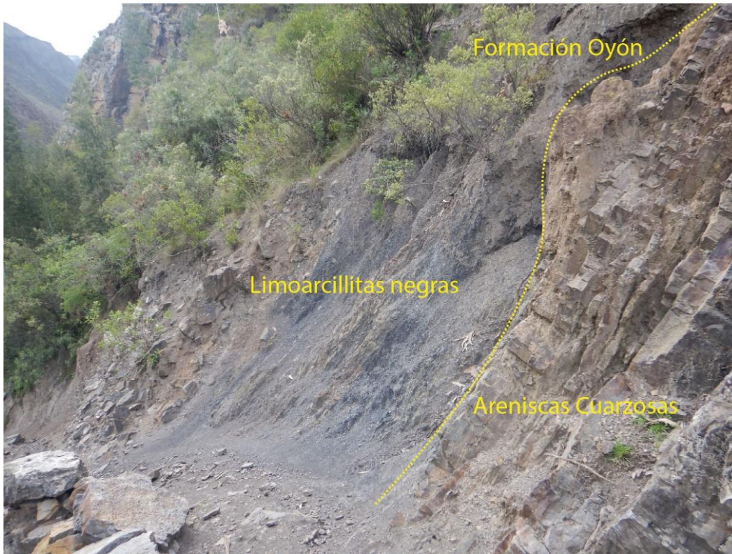
Figura 5. Se observa la intercalación de areniscas cuarzosas y limoarcillitas negras de la Formación Oyón. Las areniscas se encuentran altamente fracturadas, y las limoarcillitas de capas delgadas muestran erosión diferencial evidente en comparación con las capas de areniscas (Coordenadas: 258832 E, 8959194 N).
