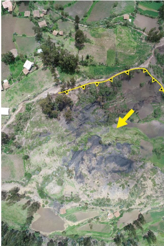
Figura 25. Muestra el escarpe principal del deslizamiento 2 (DES-2), donde se aprecia material suelto detrítico de composición limoarcillosa color negro. (Coordenadas: 259299 E, 8959518 N).
