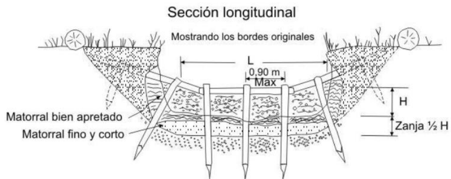
Figura 33. Obras hidráulicas transversales para el control de erosión en cárcavas.
