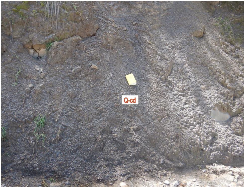
Figura 5. Depósitos coluviales formado por fragmentos de roca angulosos de tamaño variable envueltos en una matriz limoarcilloso.
