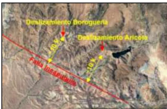
**Figura 16.** Ubicación de los deslizamientos Borogueña y Aricota, respecto a la falla Incaquiquio.
