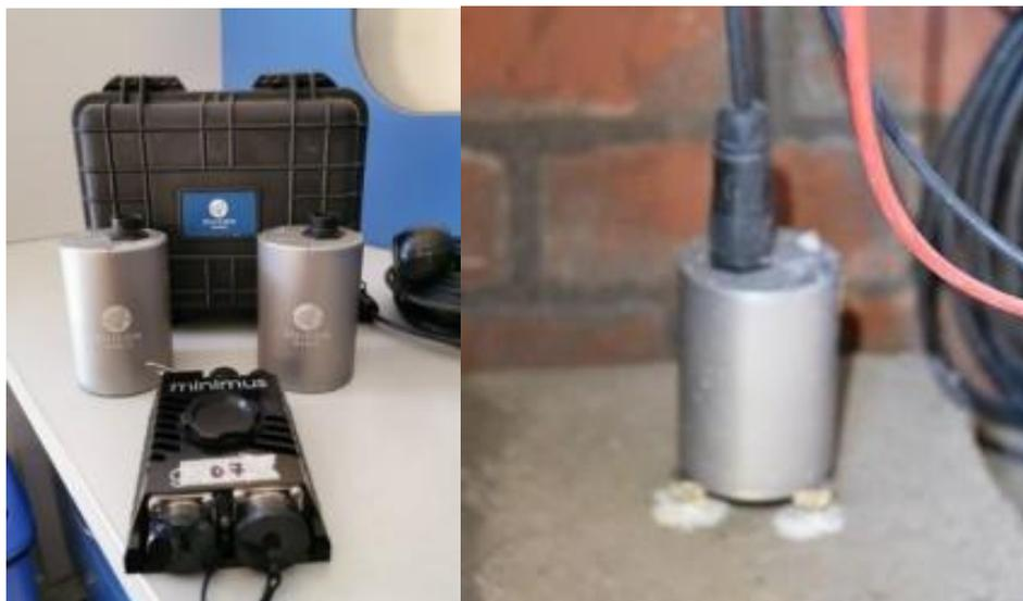
Figura 9. Izquierda: Sensor sísmico SILICON y digitalizador MINIMUS; Derecha: Sensor SILICON instalado en campo.
