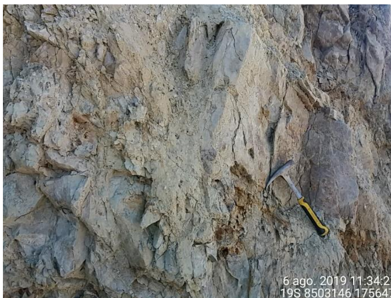
Fotografía 4: vista de las lutitas y areniscas altamente fracturadas. Fuente: Equipo Técnico PM41ZRE
