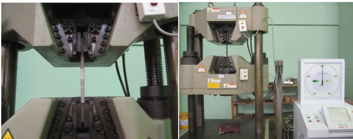
**Foto 29.** Ensayo de tracción de muestras de acero
