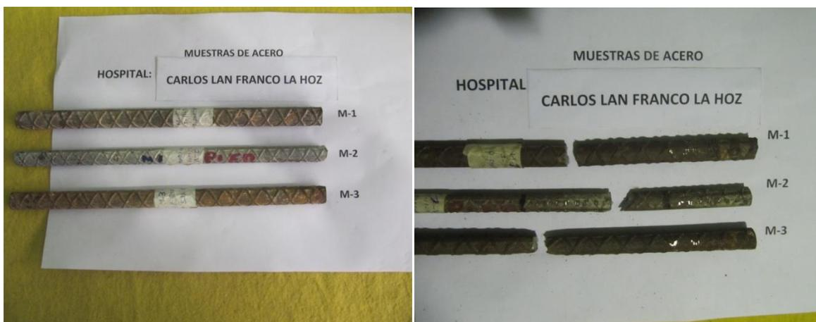
**Foto 28.** Muestras de acero, antes y después del ensayo de tracción.
