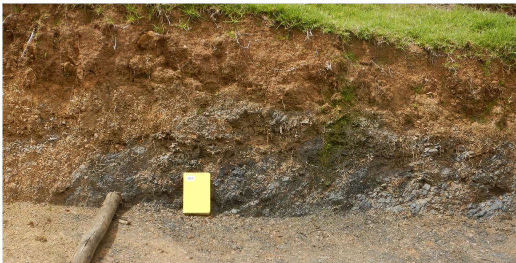
Fotografía 01: Muestra suelos de composición arcillosa cubriendo lutitas carbonosas de la Formación Chicama.
