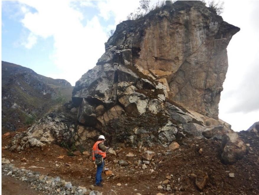
**Fotografía 4.** Calizas de la Formación Chambará, las cuales se encuentran medianamente fracturadas a muy fracturadas.
