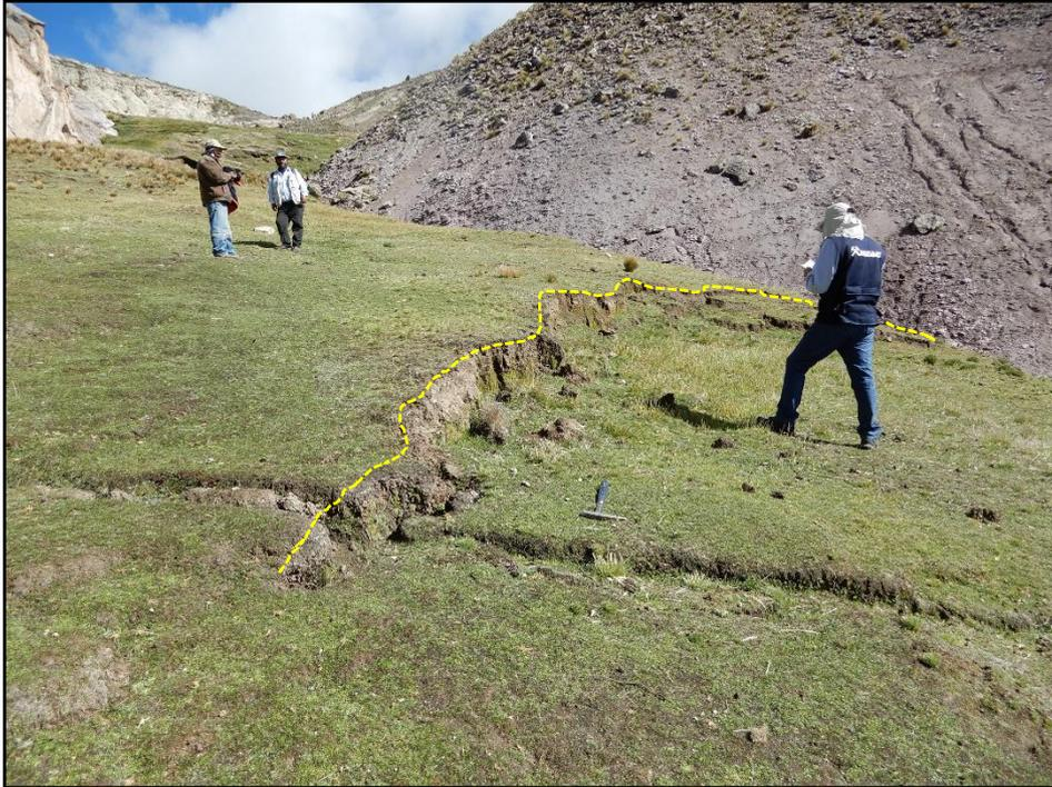
**Figura 15.** Agrietamiento en la parte alta del Centro Poblado Menor de Arcata. (coordenadas UTM E: 792762, N: 8335346).
