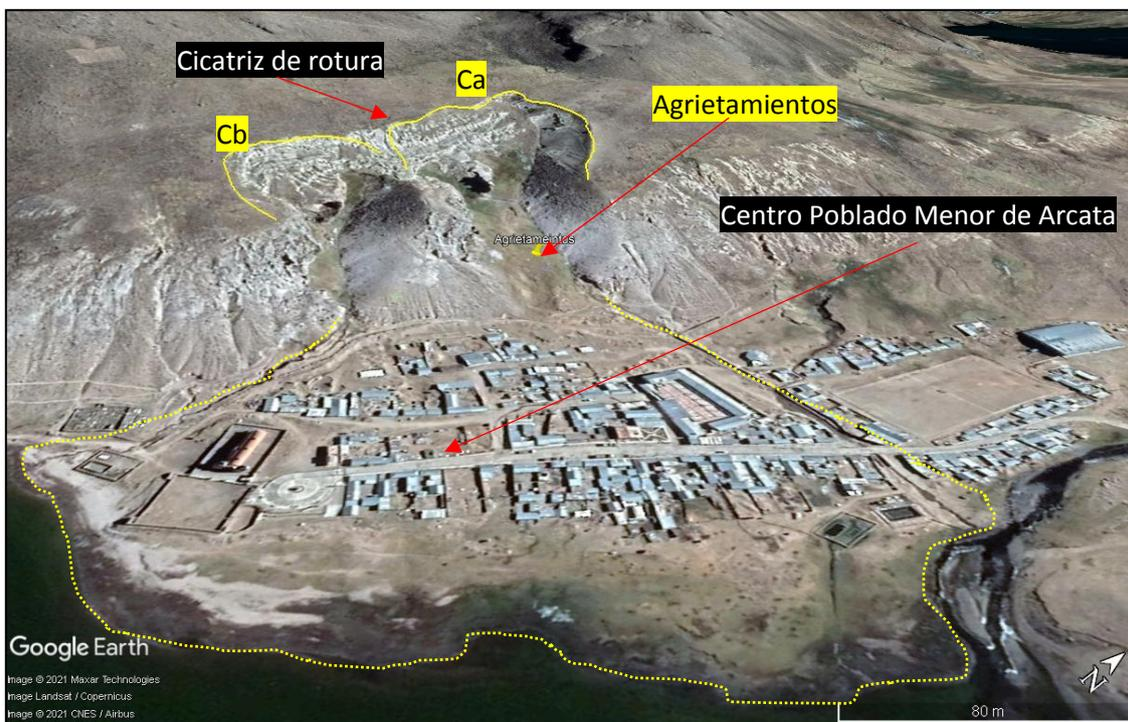
**Figura 10.** Centro Poblado Menor de Arcata, se observa la cicatriz de rotura de los flujos de tierra y los depósitos en forma de abanicos.
