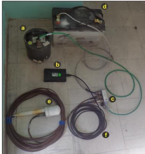
Figura 2.2. (a) Sensor sísmico GURALP modelo CMG – 6TD. (b) Disco externo. (c) Caja de conexiones externas (Break-out box), (d) Batería (Fuente de energía). (e) GPS. (f) Cable de conexión entre el disco externo y el sensor.
