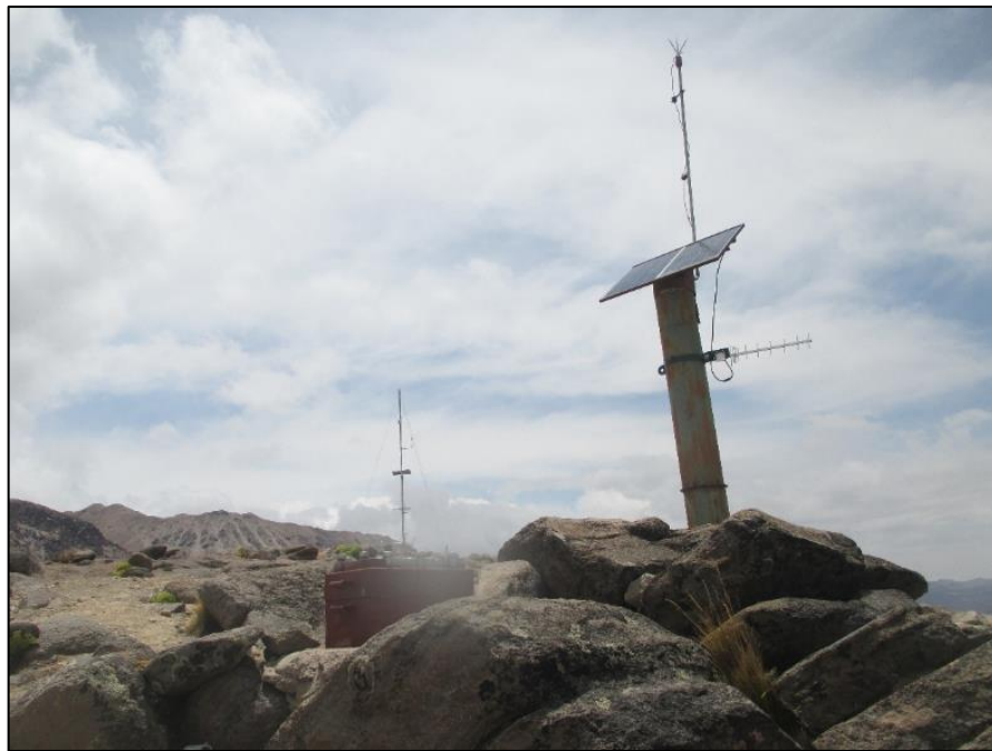
Figura 2.5. Estación sísmica con transmisión en tiempo real TIC02 , ubicada en el flanco oeste del volcán Ticsani.
