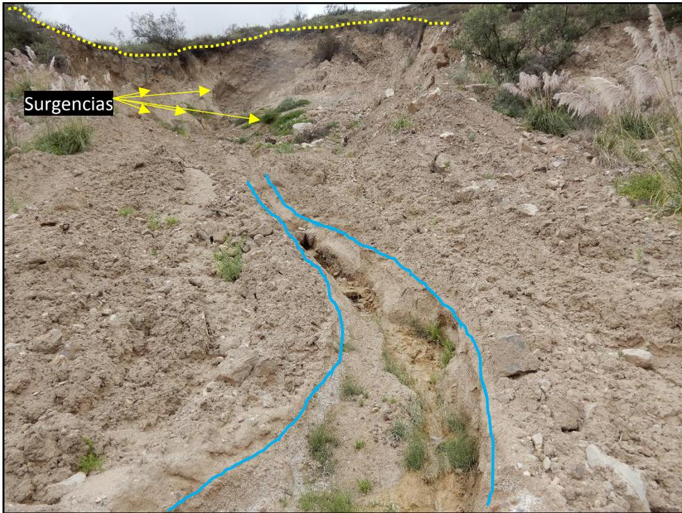
**Figura 18.** Surgencias de agua en el escarpe del flujo de tierra en el sector Quillalla. (coordenadas UTM E: 775311, N: 8258906).
