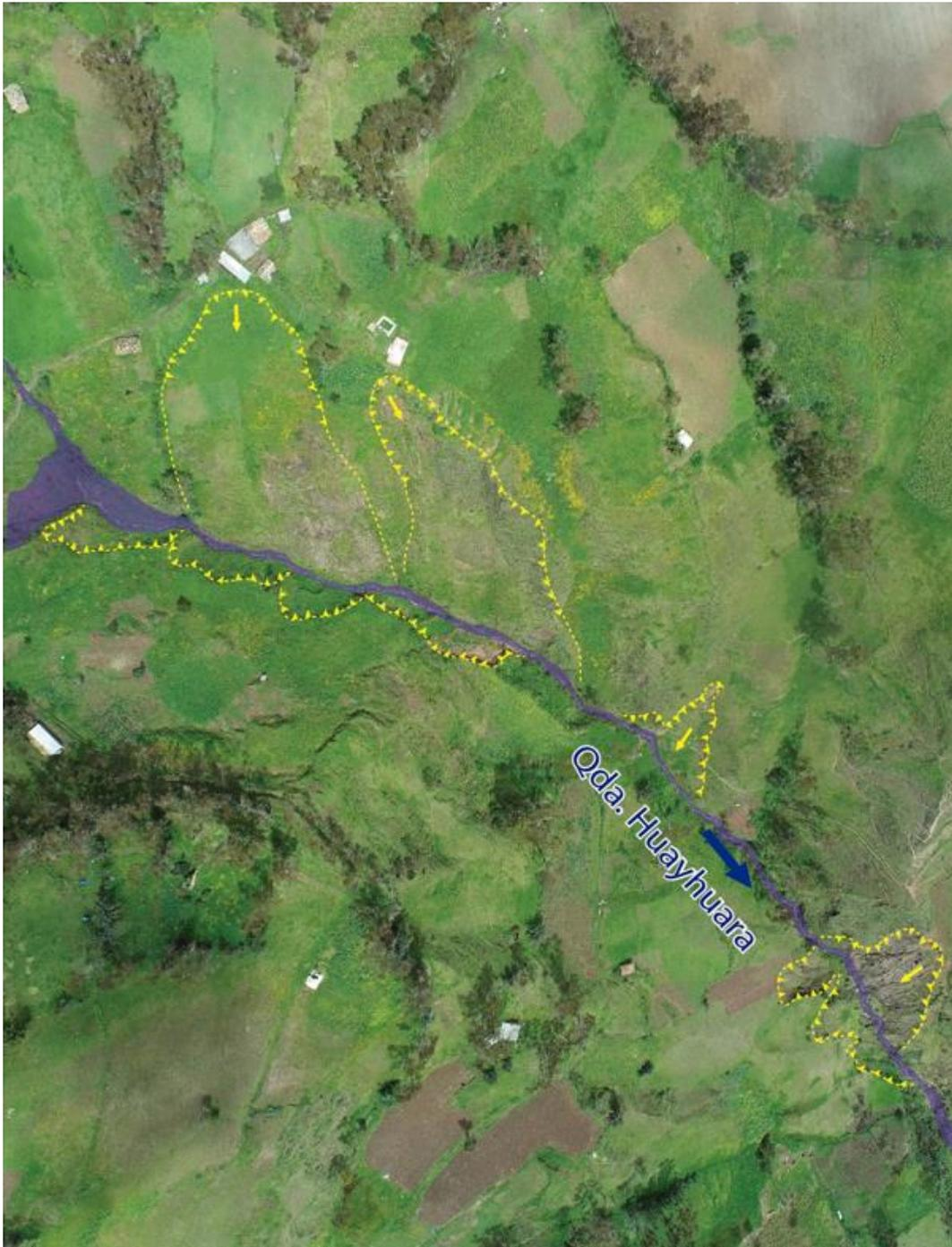
**Figura 27.** Deslizamientos recientes y reactivados a partir del flujo de detritos acontecido el año 2007, a lo largo de la quebrada Huayhuara.
