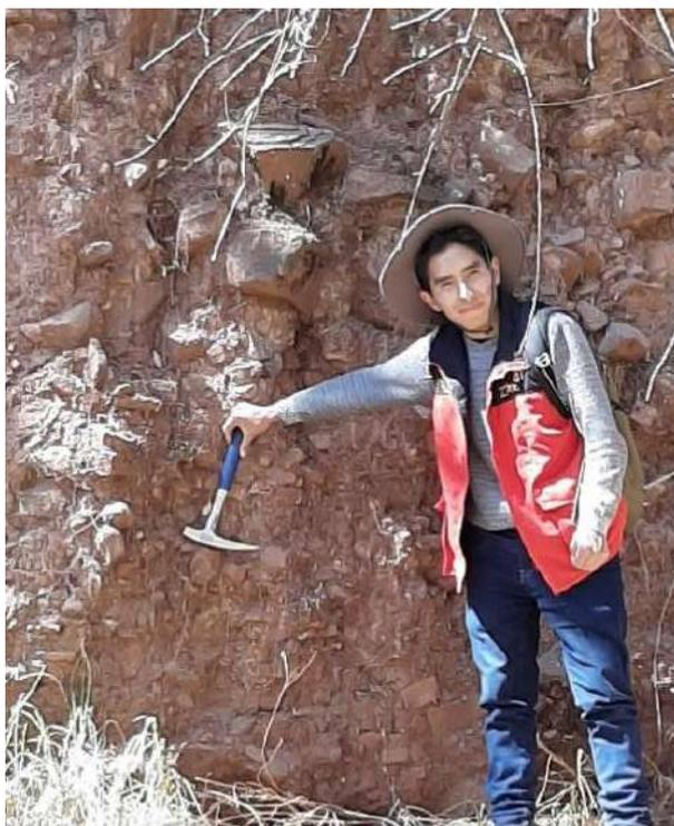
Fotografía 5: Fragmentos angulosos y sub angulosos en matriz arcillosa. Vista al NW de la zona de estudio con coordenadas E: 175850, N: 8502425
