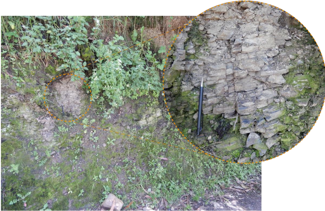
Figura 4: Afloramiento de limoarcillitas de color beige de la Formación Carhuaz, en el sector Huantay. Estas rocas se encuentran muy fracturada, con espaciamentos muy próximos entre sí y aberturas milimétricas.
