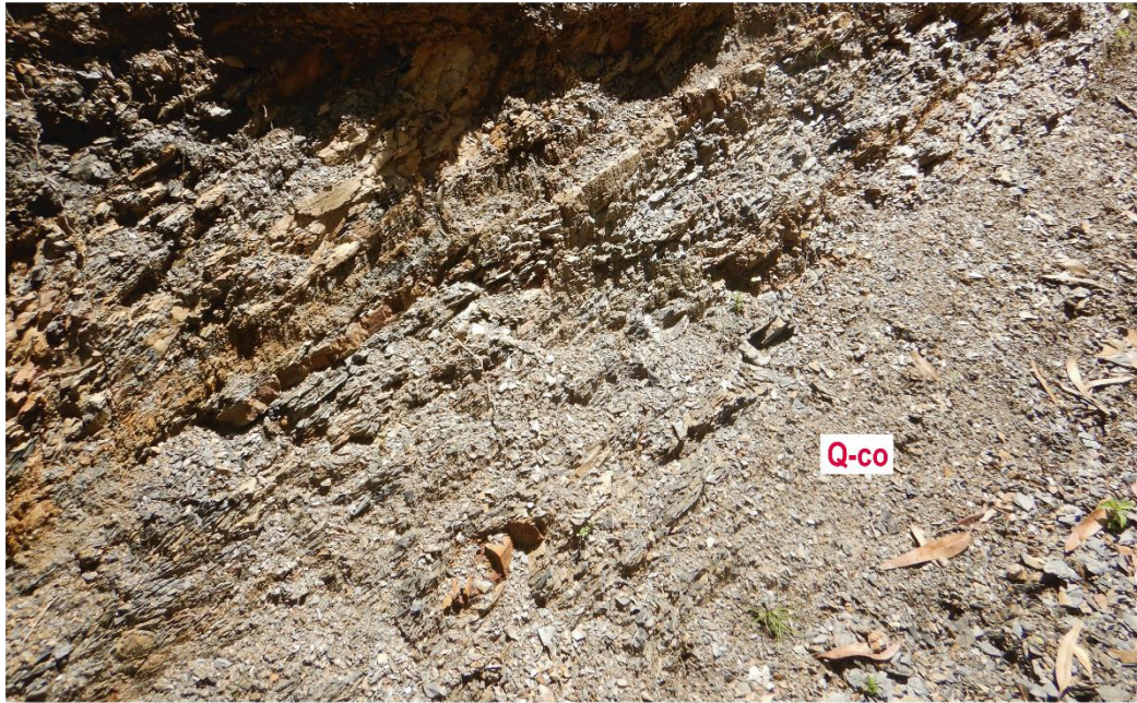
Figura 5. Depósitos coluvio deluvial formado por fragmentos de roca angulosos de tamaño variable envueltos en una matriz limoarcilloso.
