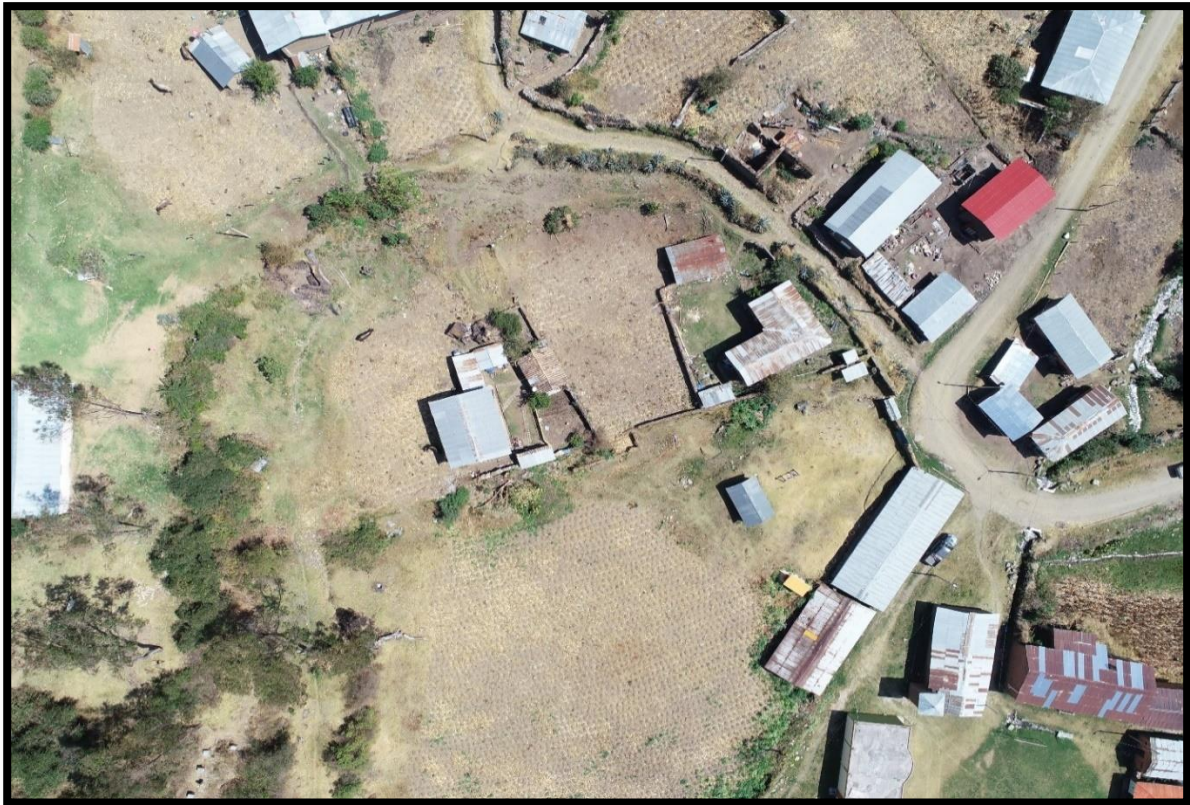
Imagen N° 26: Vista en planta de las viviendas, cuyo material predominante de sus techos es la calamina, material que es frágil ante la ocurrencia del fenómenos por flujo de detritos.
