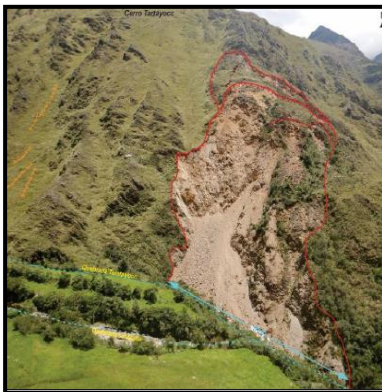
Imagen N° 21: Vista del derrumbe (líneas de color rojo) en laderas del cerro Tartayocc, con dimensiones de 64 m de ancho y altura entre el escarpe y el pie de 105 m, y presencia de grietas longitudinales (líneas de color naranjas).
