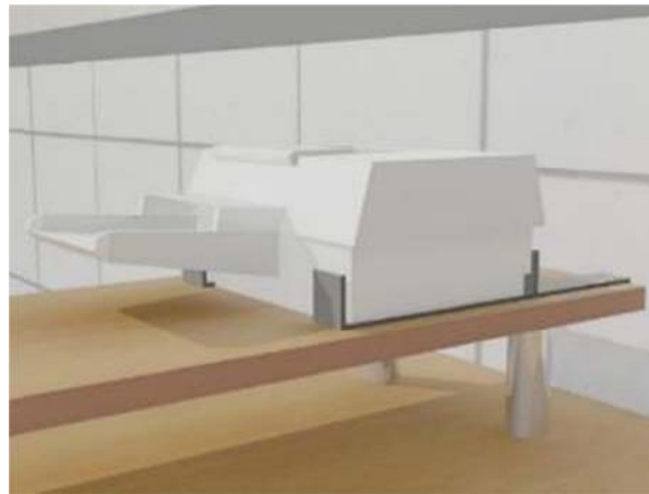
Figura 181: Equipos como impresoras deben estar sujetos a asegurados para evitar su desplazamiento ante movimientos sísmicos.
