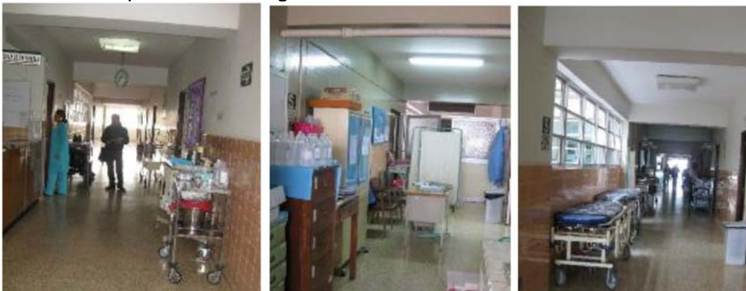
Figura 124: Derecha e Izquierda: En el bloque D y C las camillas y equipo médico que interrumpen la circulación en el corredor. Centro: En el bloque D, el equipo médico solamente colocado sobre el mueble y no sujeto con algo para evitar su desplazamiento.
