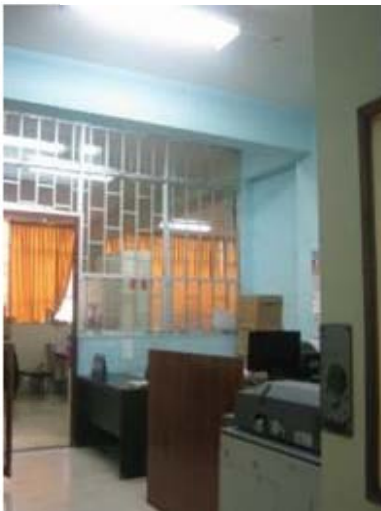
Figura 104: En el bloque C, Armario y estanterías no fijados a pared, piso o techo, tienden al volcamiento en casos eventuales de sismos. Otro factor, es el desplazamiento de los contenidos por no estar asegurados. Asimismo, se aprecia sobrecarga por apilamiento adicional de objetos sobre las estanterías o por cargas que sobrepasan la capacidad máxima del elemento, existe riesgo de caída.
