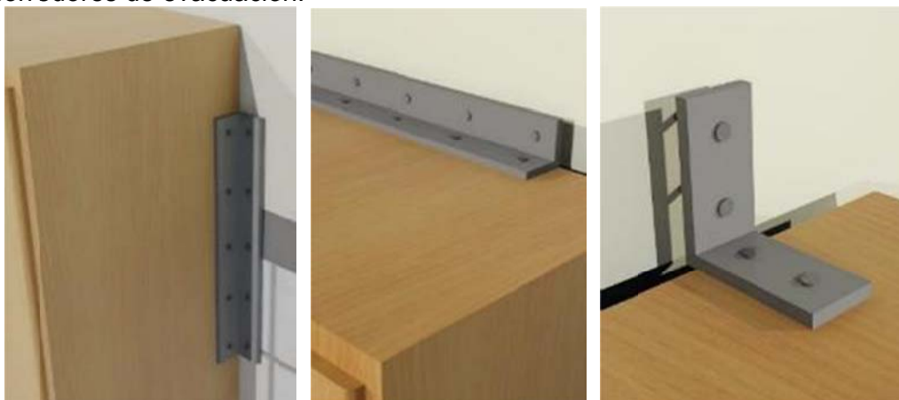
Figura 184: Los sistemas de aseguración pueden ser de diferentes tipos, en las zonas laterales o partes superior, el objetivo es contar con puntos de sujeción ante volcamientos o caídas
