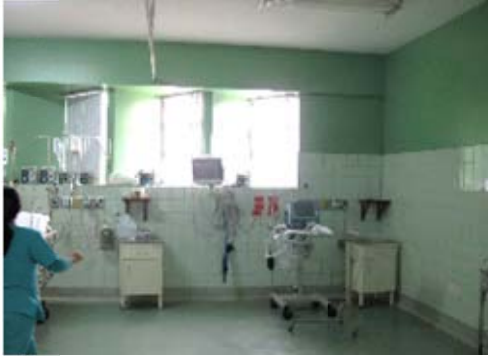
Figura 129: En el bloque C en algunos casos el equipo médico se encuentra bien sujeto y anclado a la pared; sin embargo, hay otros que se encuentran solamente colocados sobre el muro bajo tendiendo a un posible desplazamiento ante cualquier eventualidad.
