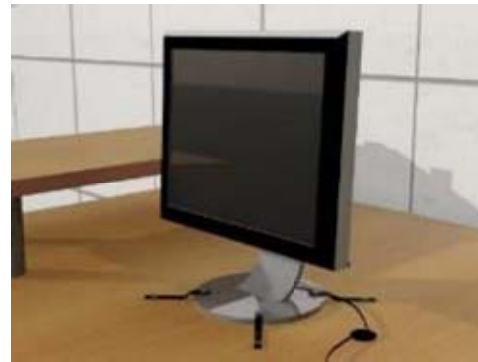
Figura 180: Monitor fijado con correas al mueble de escritorio y evitar su caídas ante movimientos sísmicos
