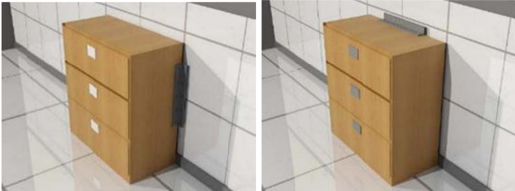
Figura 182: Archiveros deben estar asegurados y evitar caídas que obstruyan salidas o corredores de evacuación.
