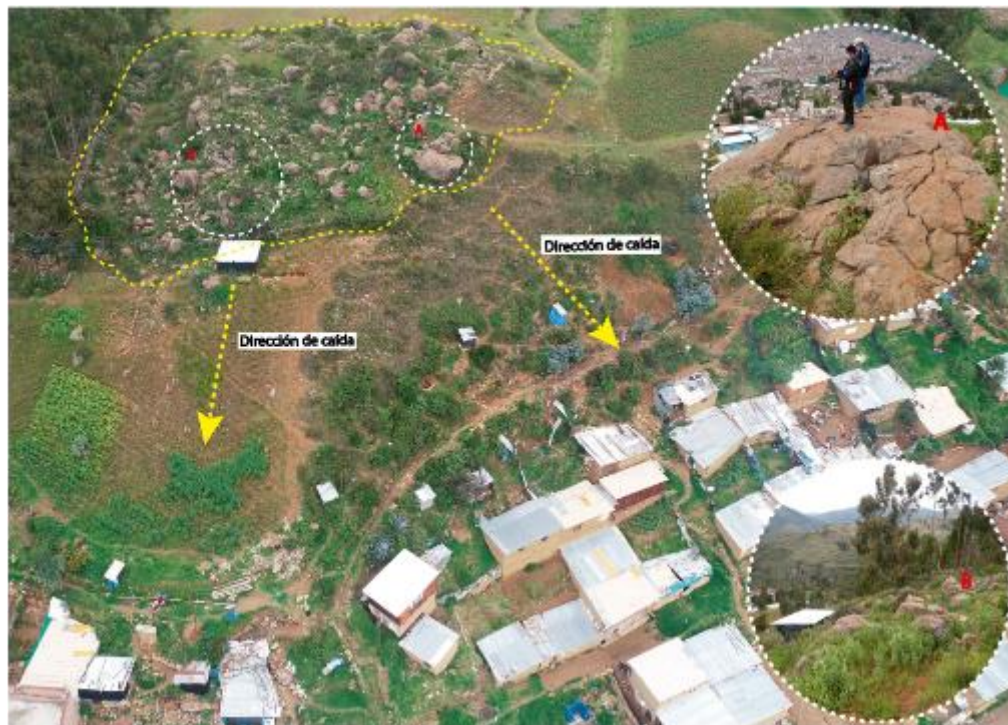
Figura 12. Zonas susceptibles a caída de rocas, y su posible dirección de desplazamiento. Ubicado en las coordenadas: 8946435 N, 220687 E, 3264 m s.n.m.
