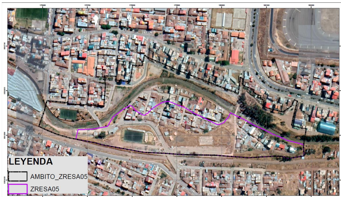
Imagen 6: Geodinámica actual en la que se observan las quebradas rellenas con presencia de áreas urbanas.
