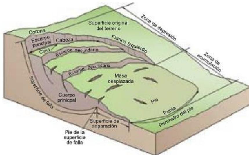
Figura 45. Diagrama de bloque de un deslizamiento (WP/WLI, 1990).
