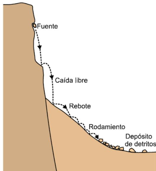
**Figura 48.** Esquema de la caída de rocas (Varnes, 1978).
