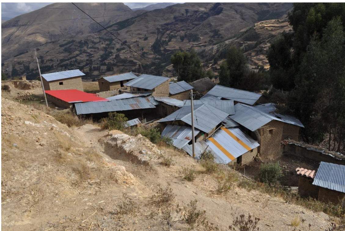
Sector de Huancané, se observan construcciones de vivienda de adobe y techo de calaminas.
