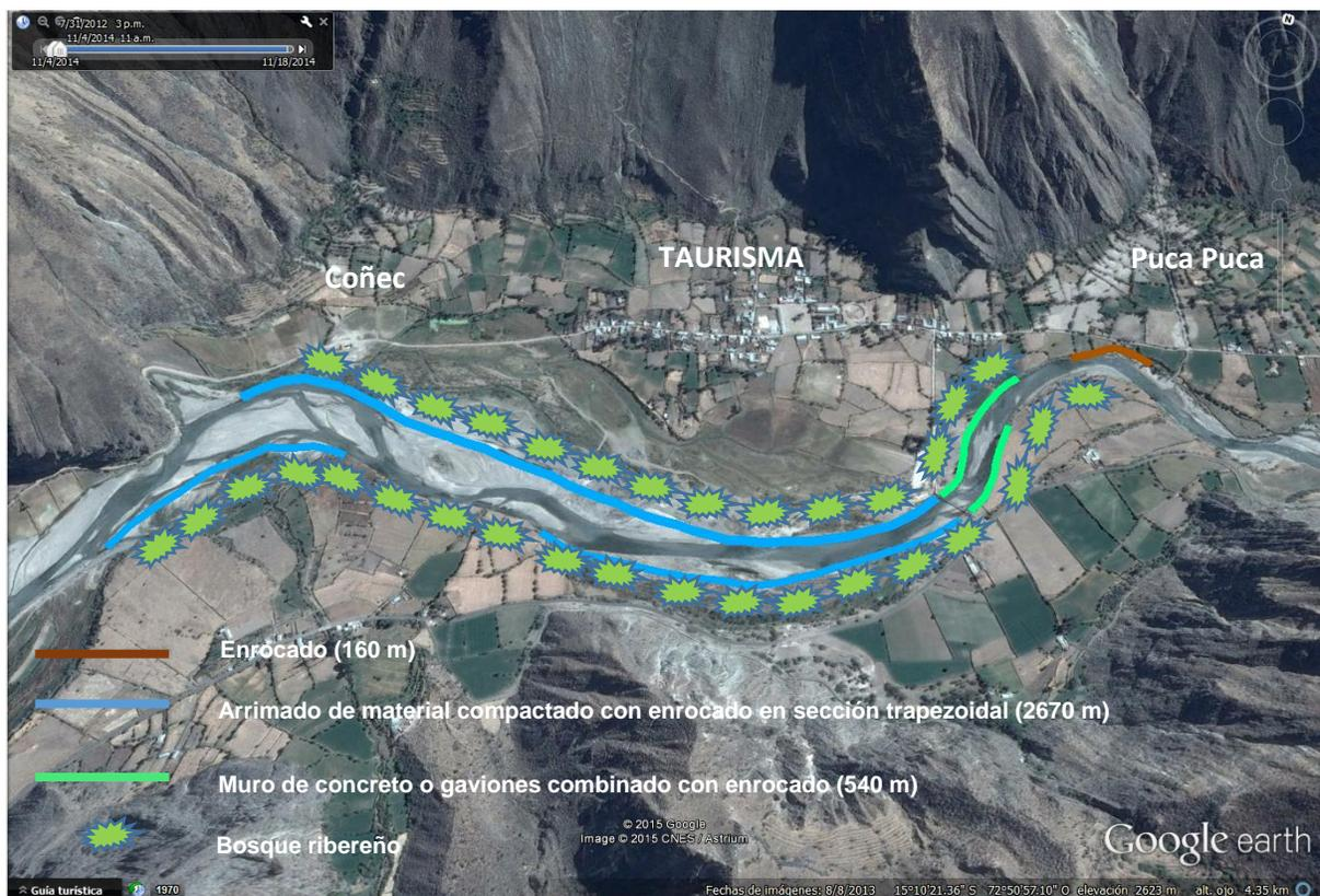
Figura 21. Figura esquemática de medidas a desarrollar contra inundaciones y erosión fluvial. Las longitudes estimadas son: 160 metros de enrocado en Puca Puca; 540 metros de muro de concreto combinado con enrocado, aguas arriba de puente peatonal; 1260 m (margen izquierda) y 1410 m (margen derecha) de arrimado de material compactado del lecho del río de sección trapezoidal, combinado con enrocado de talud húmedo<sup>7</sup>.
