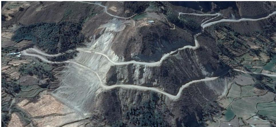
Figura 11. Imágenes satelitales oblicuas de los años 2010, 2012 y 2014, donde se aprecia el avance de deslizamiento que afecta un tramo de la carretera de acceso a Cotahuasi en la zona de Cachana. La fuerte meteorización en las rocas que componen los taludes cortados, la convierten en una zona de alta susceptibilidad a deslizarse en presencia de agua, fuerte pendiente en los taludes de corte.
