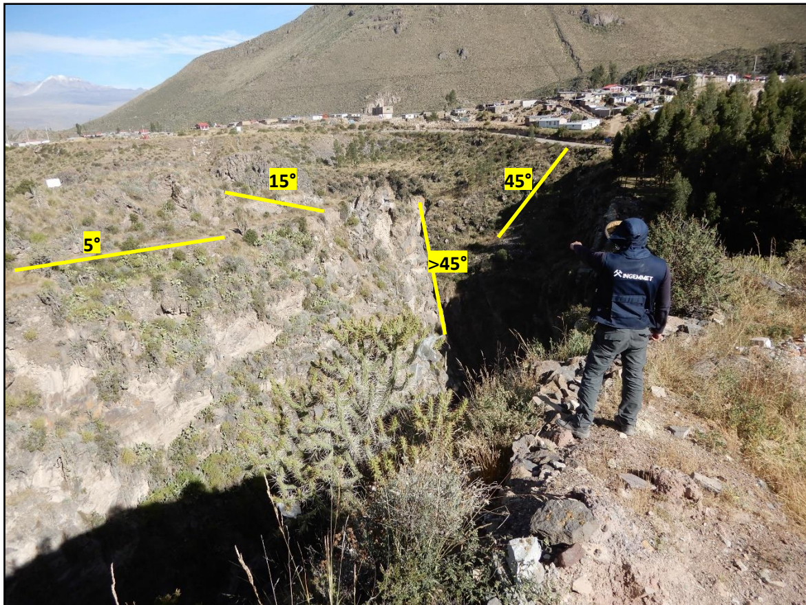
Figura 9. En a) Muestran las distintas pendientes en el sector Munaypata, (coordenadas UTM E: 220491, N: 8269984)
