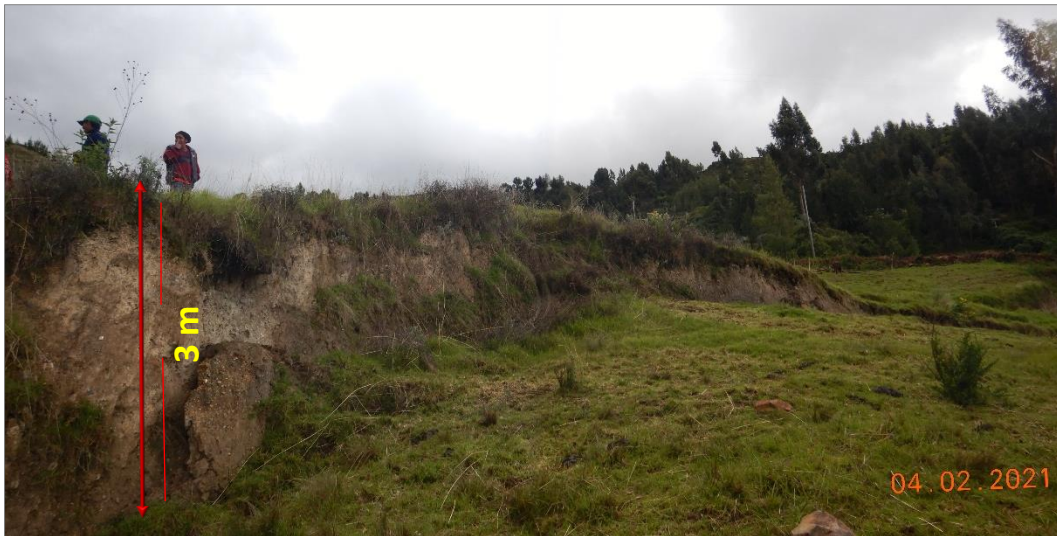
Figura 9. Vista del escarpe de forma semicircular, reactivado, con un salto de 3 m., con coordenadas UTM (WGS 84): 229788 E, 8469342 N a 3619 m s.n.m.
