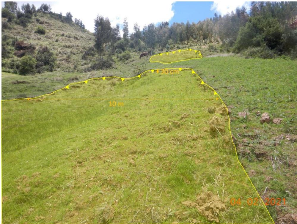
**Figura 10.** Vista tomada en coordenadas E 230172; N 8465566. Muestra la ubicación de la reactivación de los deslizamientos, que afectan áreas agrícolas.
