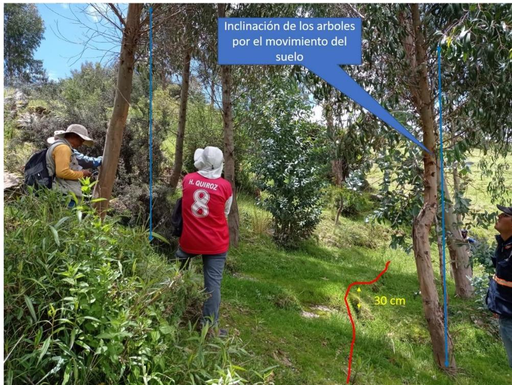
**Figura 12.** Vista tomada en coordenadas E 230419; N 8465566. Muestra la reactivación de deslizamiento con grieta y desnivel del terreno de 30 cm de altura, además se observa que los árboles tienen inclinaciones a causa de estos movimientos.
