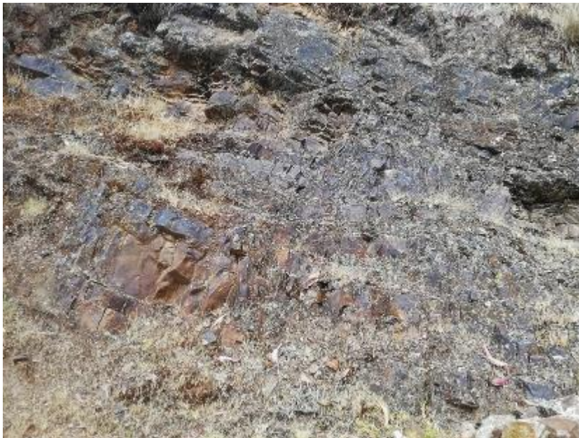
Fotografía 1. Sustrato rocoso conformado por areniscas de grano fino color gris de la Formación Cachíos. Estas rocas se presentan muy fracturas y altamente meteorizadas.
