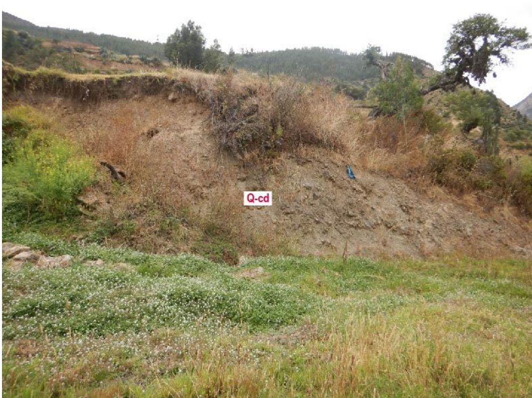
Figura 6. Depósito coluvio deluvial formado por fragmentos de roca angulosos de tamaño variable envueltos en una matriz limoarcilloso.
