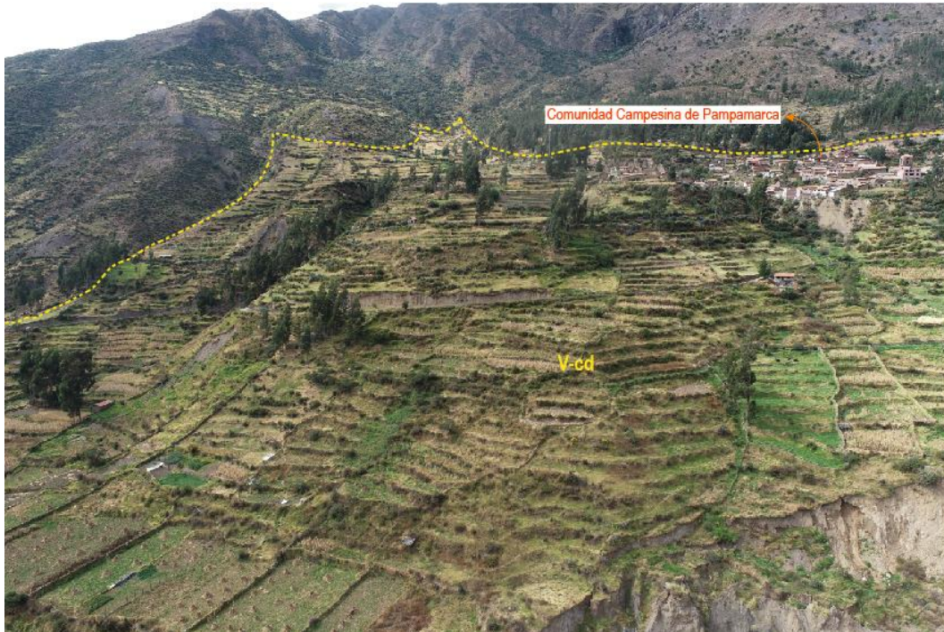
Figura 10. Vista con dirección al este, donde se observa subunidad de vertiente coluvio-deluvial (V-cd), sobre la cual se encuentra asentada la Comunidad Campesina de Pampamarca, al pie de la vertiente coluvio-deluvial se produjieron los deslizamientos..
