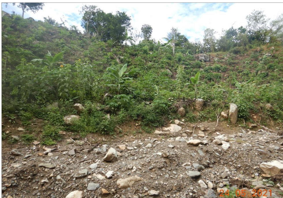
Fotografía 3. Depósito coluvio-deluvial, localizado en la margen derecha de la quebrada Miraflores compuesto por bloques con diámetros que varían de 0.3 a 1.5 m.
