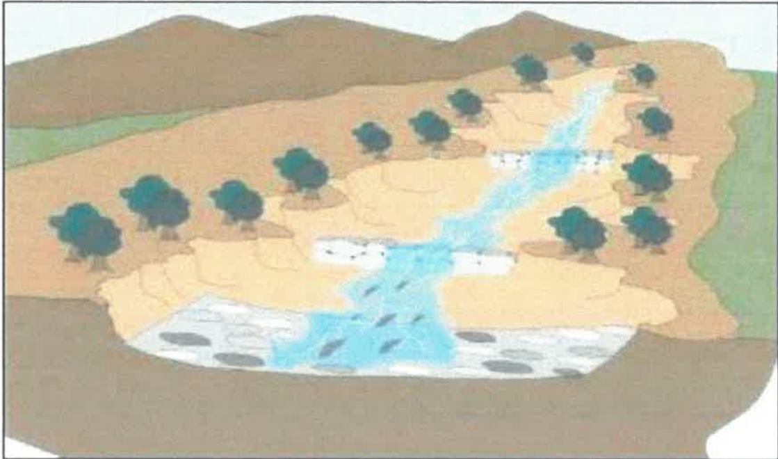
Imagen N°. 16 Presas de sedimentación escalonada para controlar la fuerza destructiva de los huaicos Fuente: INGEMMET, 2020
