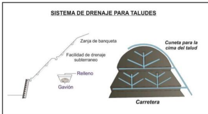
Figura 18: Sistema de drenaje tipo espina de pez. Fuente: Gómez, (2017) – Informe técnico N° A6753, “Peligro por deslizamiento en el sector Lluscapampa”
