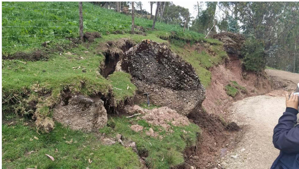
Fotografía 9. Se observa bloque de roca conglomerádica rodada con 2.10 m de diámetro ubicado en el talud superior de la carretera.
