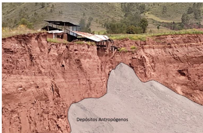
Fotografía: Depósitos antropógenos, cantera de material de uso industrial Fuente: Equipo Técnico PM41ZRE.
