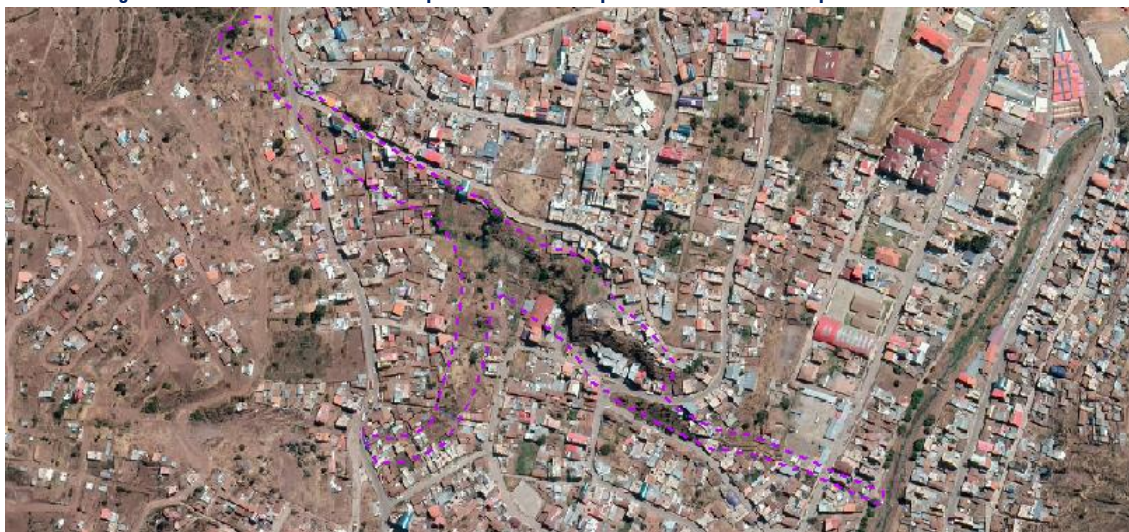
Imagen N° 9: Geodinámica actual en la que se observan las quebradas rellenas con presencia de áreas urbanas.
