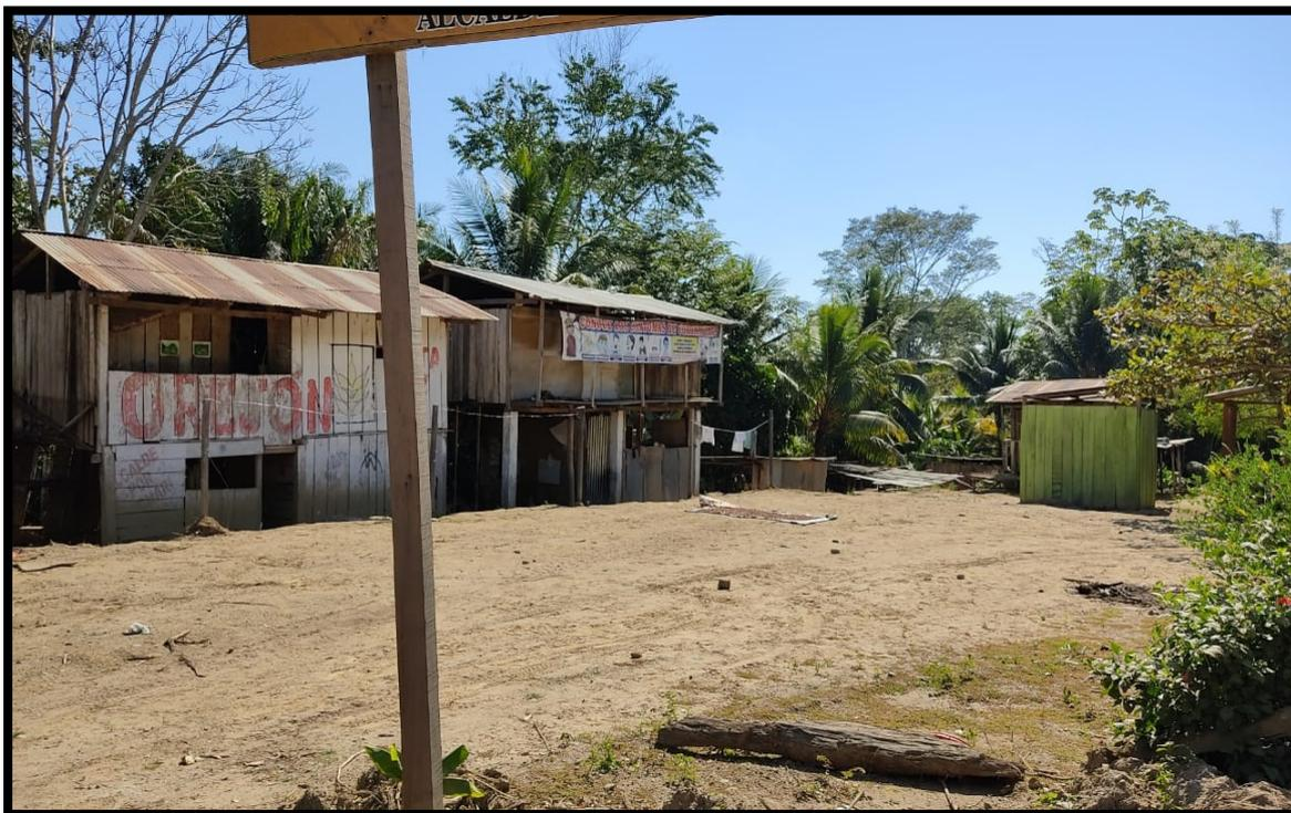
**Fotografía N° 2:** Viviendas construidas con materiales predominante en paredes exteriores como madera y/o triplay.
