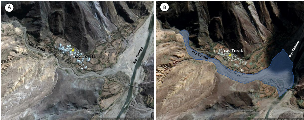
Figura 13. a) Imagen Google Earth 2010, la cual muestra el cauce de río Torata reducido, cuyas terrazas se encuentra ocupadas por terrenos de cultivo del poblado San Cristóbal. b) imagen Google Earth 2019, claramente se puede evidenciar que hubo un evento de flujo de detritos, se observa ensanchamiento del cauce de río Torata y pérdida de áreas de cultivo.
