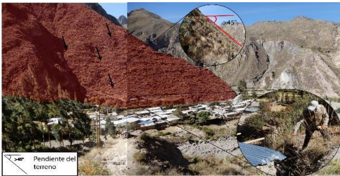
Figura 10. Zona de caídas de rocas. Ubicación: Ladera izquierda del centro poblado de Torata (UTM: 313770E, 8191576N, 19S).
