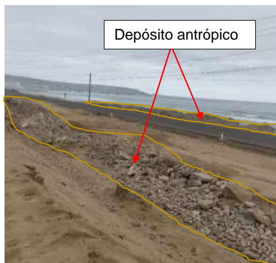
Figura 08. Identificación de depósito antrópico (desmonte y basura) sobre la planicie aluvial compuesta por arenas y fragmentos subredondeados en su mayoría intrusivos.
