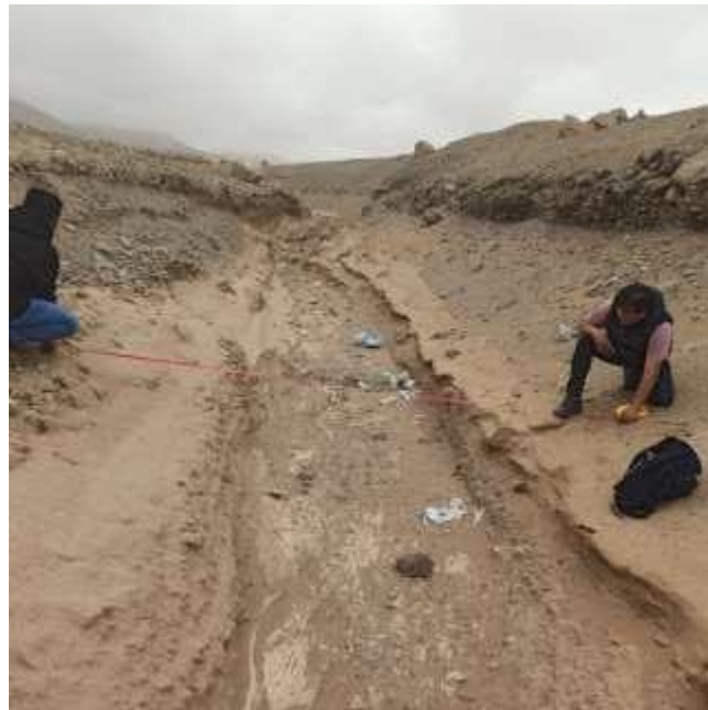
Figura 23. Medición de altura de flujo en el cauce de la quebrada Zaparo de 40 cm, 75 cm y sedimentos inestables y granulares de pequeñas terrazas de 1.10 cm de altura a más.
