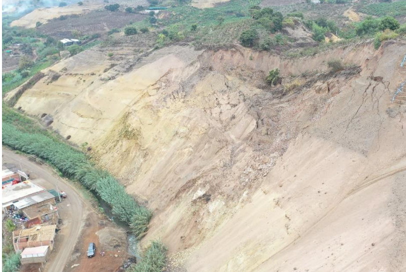
Fotografía 4. Depósito coluvial conformado por materiales de deslizamiento reciente. Fuente: Imagen tomada con drone Mavic 2 Pro.
